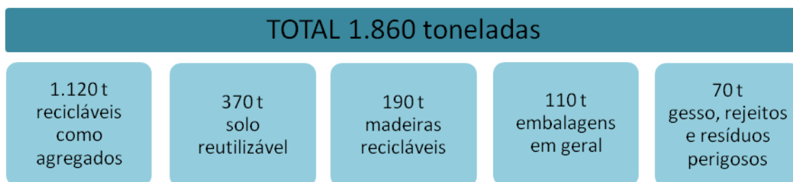
Figura 9 – Estimativas de geração de RCC por tipo de material. Fonte: I&T, 2009.
