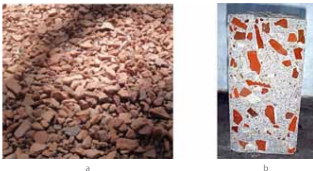
Figura 14 – (a) Resíduo de material cerâmico e (b) Corpo-de-prova de concreto com material cerâmico.
