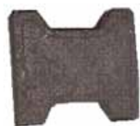
Figura 18 – Bloco de pavimentação com agregados reciclados.
