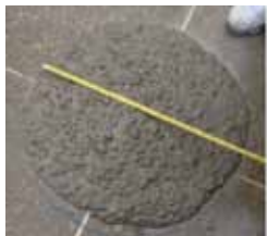
Figura 17 –(a) Ensaio de espalhamento no concreto auto-adensável e (b) Corpo-de-prova rompido.
