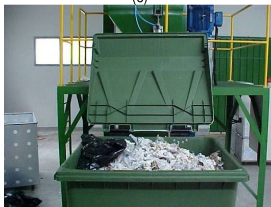
Figura 12 - Sistema de autoclave utilizado no tratamento de resíduos de serviços de saúde no Município de Betim
